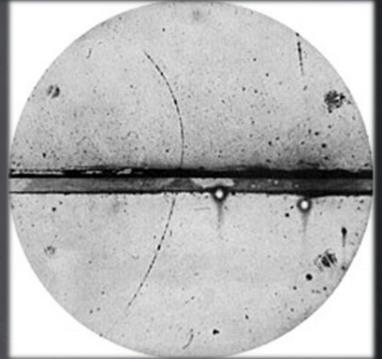
Anderson ködkamrafelvétele a pozitron nyomáról. 6 mm-es ólomlemez választja el a kamrát, amelyen áthaladva az energiát veszít, lehetővé téve a mozgásirány meghatározását.
